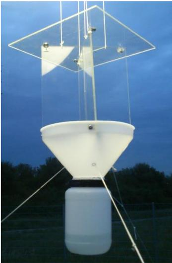
Lichtfallen wurden eingesetzt, um einen Überblick über die angelockten Insekten am Ordnungsniveau zu erhalten. Diese Fallen, auch Luftelektoren genannt, fangen die an das Plexiglas anprallenden Insekten in einem Gefäß mit Tötungsmittel unterhalb eines Trichters (siehe Abbildung 4). Sie wurden bereits in der vorangegangenen Studie (SONEIRA 2013) verwendet.
