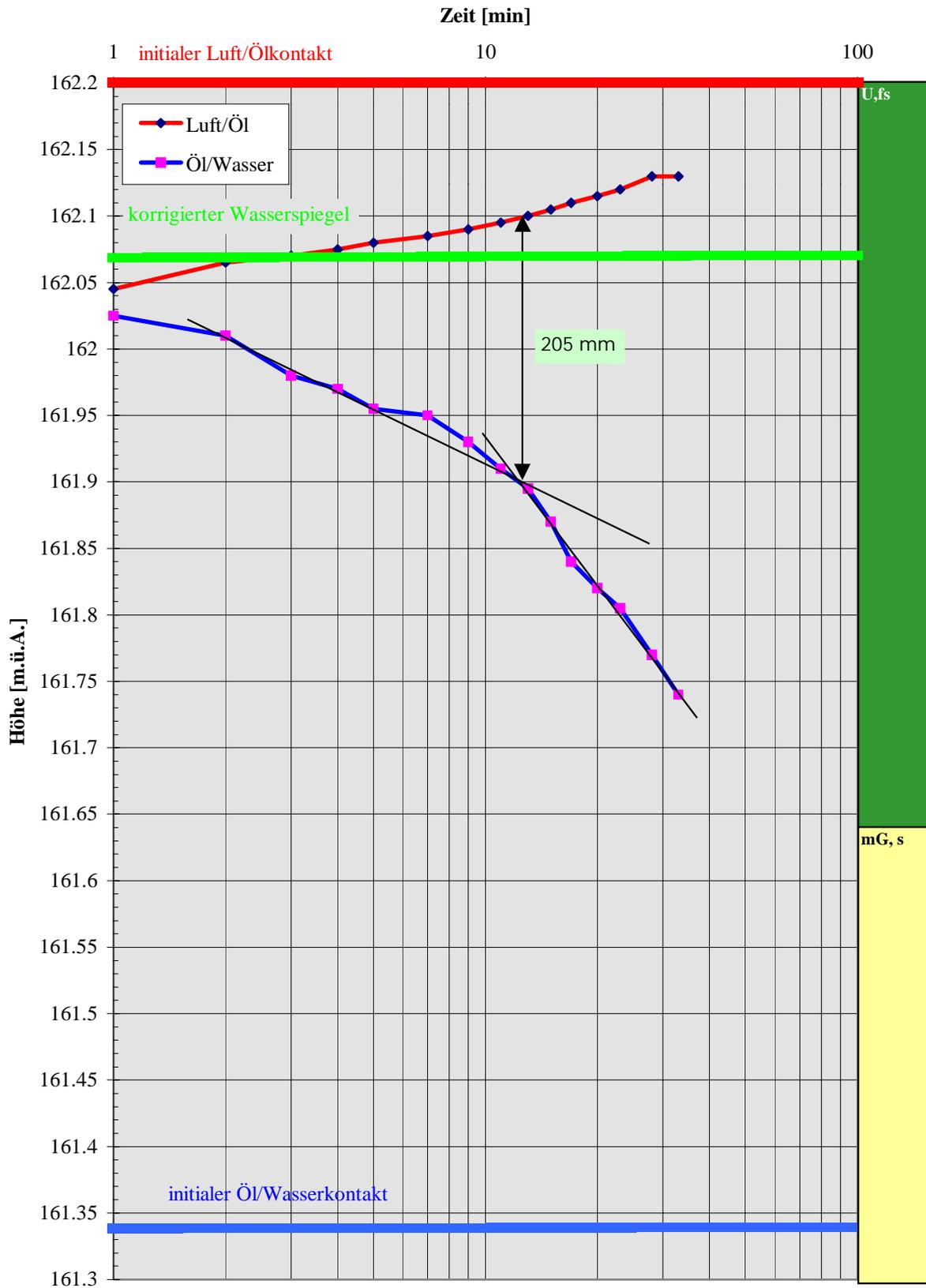
Abbildung 10: Auswertung eines Bail-Down Tests
